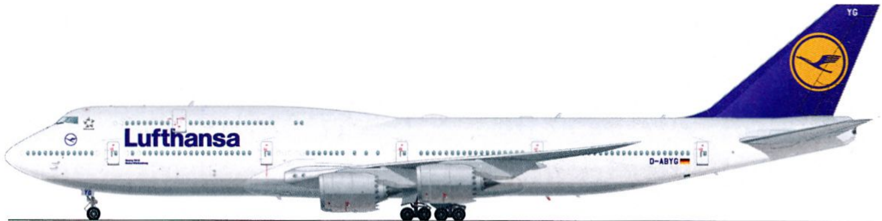
Boeing 747-8 (1969- ) 空虚重量:213 t 最大離陸重量:442 t
