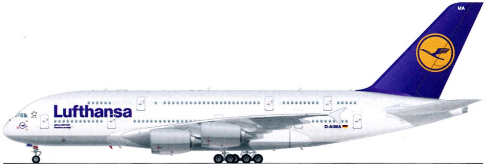
Airbus A380-800 (2005- ) 空虚重量:277 t 最大離陸重量:560 t
