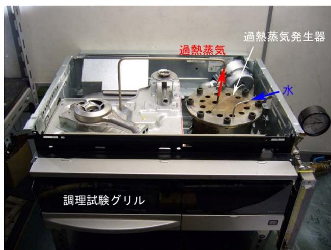
ガスレンジに組み込んだ過熱蒸気発生器
