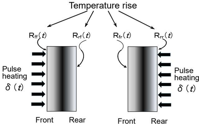
図4 パルス加熱法による平板（沿面方向に均質、厚さ方向の熱物性値変化は可）のインパルス応答関数成分毎に表示すると、
