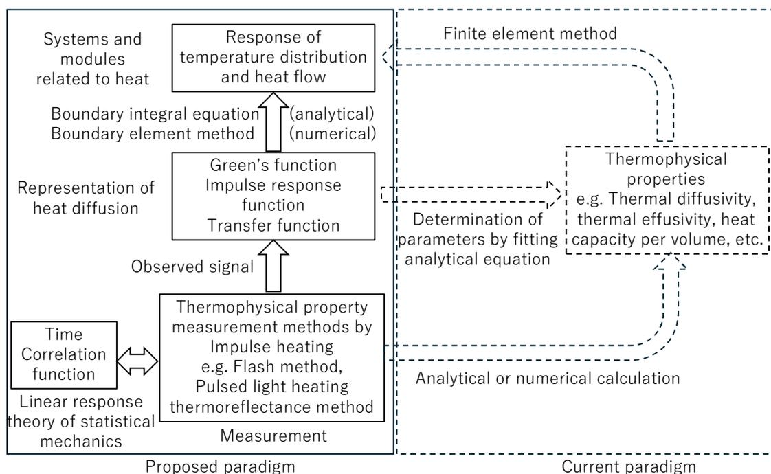
図7 パルス加熱法により測定されるインパルス応答関数とグリーン関数に基づく固体中エネルギー拡散の体系的記述
