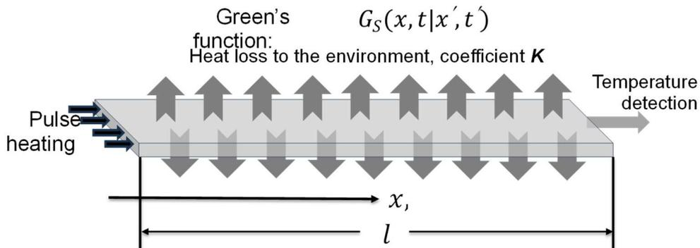
図5 フラッシュ法（パルス加熱法）による薄板状試料の沿面方向熱拡散率測定の幾何学的配置とグリーン関数
